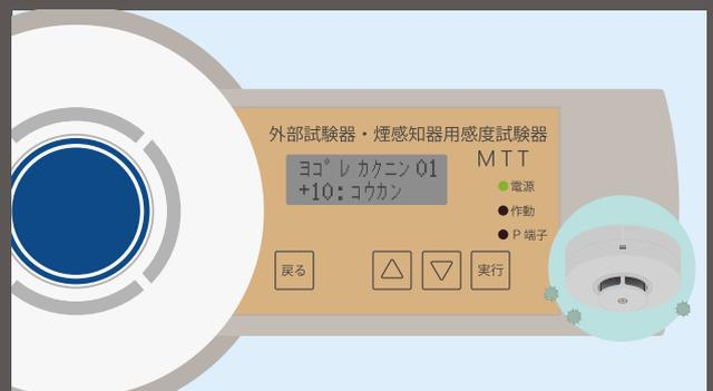
予防保全のために煙感知器内部の汚れを遠隔で確認でき、交換目安がわかります。
