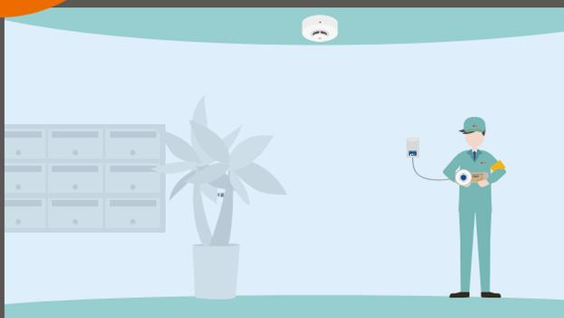
遠隔で作動試験と煙感知器の感度試験が行えます。
