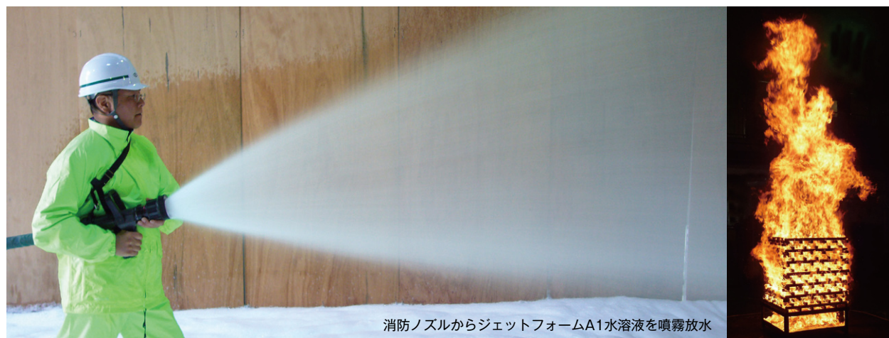
A 火災の代表的な火災モデルであるクリブモデルの燃焼写真。
